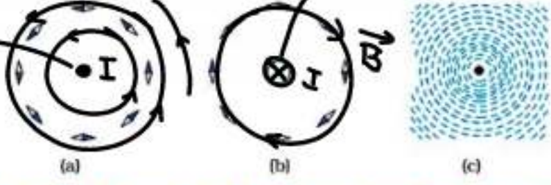
चित्र 4.1 एक सीधे लंबे धारावाही तार के कारण उत्पन्न चुंबकीय क्षेत्र। तार, कागज के तल पर अभिलंबवत है। तार के चारों ओर चुंबकीय सुइयों को एक मुद्रिका बनाई गई है। चुंबकीय सुइयों का अभिविन्यास— (a) जब धारा कागज के तल से बाहर की ओर प्रवाहित होती है। (b) जब धारा कागज के तल से अंदर की ओर प्रवाहित होती है। (c) लौह चुर्ण कणों का तार के चारों ओर अभिविन्यास। सुइयों के काले सिरे उत्तरी ध्रुव प्रदर्शित करते हैं। यहाँ धू-चुंबकत्व के प्रमाण की उपेक्षा की गई है।
